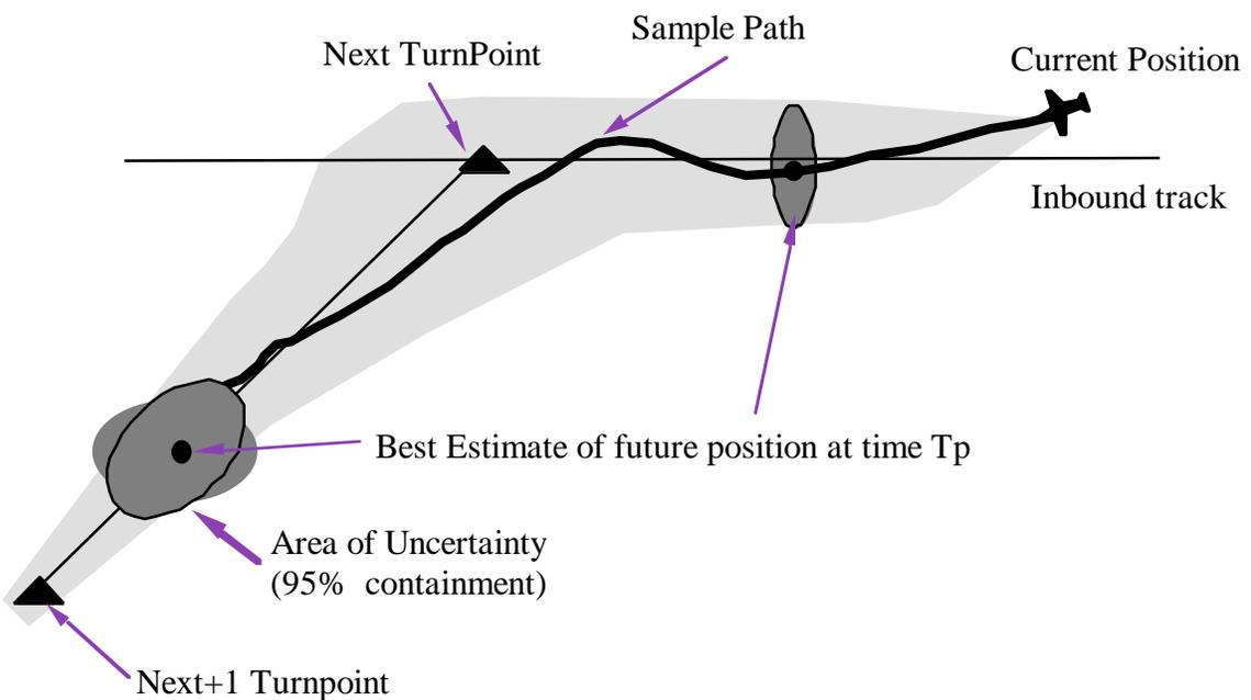
**Figure 5 - TYPICAL OPERATION OF AN AUTOMATED SEPARATION ASSURANCE SYSTEM**
